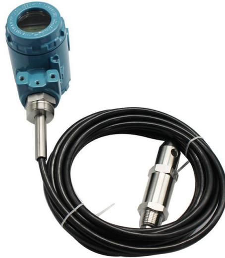
T4220 系列液位变送器是采用国际先进的扩散硅传感技术生产的压力变送器，可根据实际应用选择不同的传感芯体，采用不锈钢密封结构。可以有多种信号输出、量程测量范围较宽泛，长期稳定性好，防腐性强，适用于各种需要对流体压力进行精密测量的场所，如石油化工、环保监测、水利工程，油罐等场合的液位测量。
