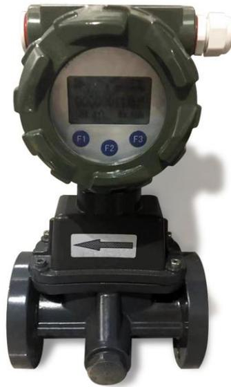
**概述** 智能旋进旋涡流量计是我公司开发研制的具有国内领先水平的新型气体流量仪表。该流量计集流量、温度、压力检测功能于一体，并能进行温度、压力、压缩因子自动补偿，是石油、化工、电力、冶金等行业用于气体计量的理想仪表。
