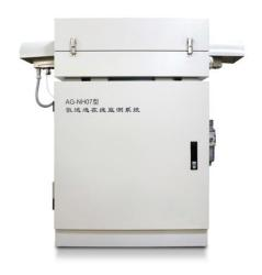
逃逸氨分析的重要性 火电厂及供暖厂的燃煤锅炉 SCR/SNCR 脱销工艺中需要对 NH3 逃逸量进行实时的在线监测,监测结果可以指导优化还原剂氨的注入量,以达到提高脱销效率的目的。同时有效地控制 NH3 逃逸量减少铵盐的生成,避免对下游设备的腐蚀和危害,延长催化剂寿命,节约运营成本。
