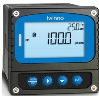
工业在线电导率仪是带微处理器的水质在线监测控制仪。该仪表广泛用于电厂、石油化工、冶金电子、矿业、纸业、半导体、医药、食品饮料、环保水处理、新型农业种植等各个行业；适用于软化水、原水、蒸汽冷凝水、海水蒸馏以及去离子水等；对水溶液的电导率值、电阻率值、TDS 值和温度值进行连续监测和控制。
